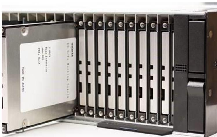
**Foto:** La imagen muestra SSDs montados en un prototipo de servidor en bastidor de tamaño 2U que instala un máximo de 48 unidades del prototipo del servidor principal del proveedor. Con la combinación del modelo de evaluación E3.S + el modelo de evaluación de servidor montado en bastidor de 2U, KIOXIA ha realizado pruebas de dispositivos de destino, tales como evaluación del rendimiento del sistema, verificación de disipación de calor, etc. con proveedores de servidores.
