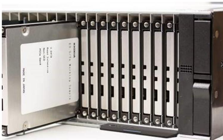
L'image montre des SSD montés dans un système d'évaluation de serveurs en rack 2U, capable d'accueillir jusqu'à 48 unités prototypes de grands fournisseurs de serveurs. En combinant son modèle d'évaluation E3.S à ce système d'évaluation de serveurs en rack 2U, KIOXIA a évalué plusieurs combinaisons cibles sur la base des performances système, de la dissipation thermique, etc. avec plusieurs fournisseurs de serveurs.
