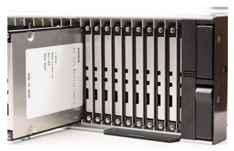
Это фотография SSD накопителей установленных в прототип сервера форм-фактора 2U. В такой прототип сервера от одного из крупнейших поставщиков можно установить до 48 накопителей. Благодаря комбинации оценочных моделей E3.S + сервера размером 2U, KIOXIA выполняет целевые оценки устройств с поставщиками серверов, такие как оценка производительности системы, проверка тепловыделения и т.д.
